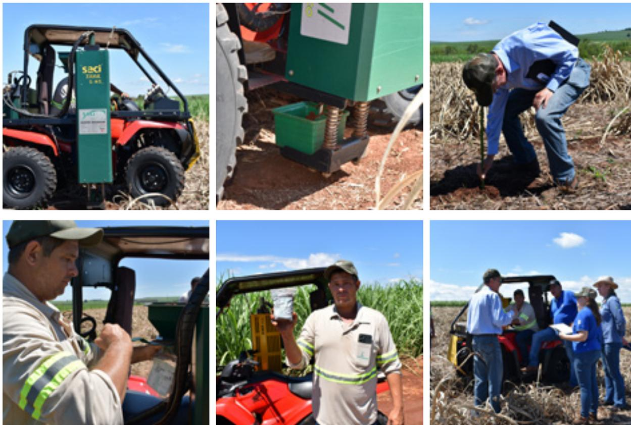
O quadriciclo realiza coletas georreferenciadas em vários pontos, utilizando uma sonda de média e alta profundidade
