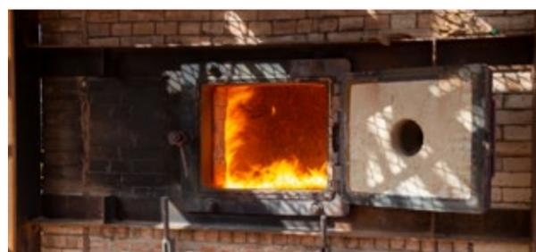
A palha da casca do amendoim pega fogo antes mesmo de chegar ao chão da fornalha. O calor gerado aquece um recipiente com água em pressão que produz o vapor que será utilizado na secagem do amendoim e da soja
